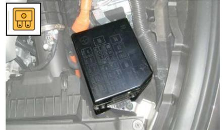
2. Dargestellte Sicherungen im Kastendeckel entfernen.
